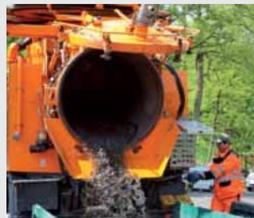
Am Ende des Arbeitstages wird der gesammelte Kanalschlamm am Hauptklärwerk in einen speziellen Container entsorgt. Das mehrfach benutzte Spülwasser wird anschließend direkt in den Zulauf des Klärwerks eingeleitet.
