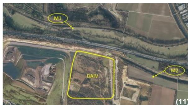
Zudem wird ein Grundwassermonitoring an mehreren Messstellen im Bereich/Umfeld des DA IV für das untere und obere Grundwasserstockwerk durchgeführt. Das vorhandene Messstellennetz wird um zusätzliche Grundwassermessstellen im Umfeld des DA IV erweitert.
